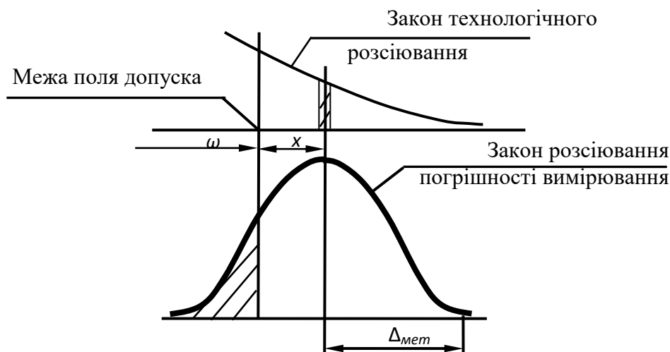
Рис.2 – Взаємодія похибки вимірювання і технологічного розсіювання розмірів
