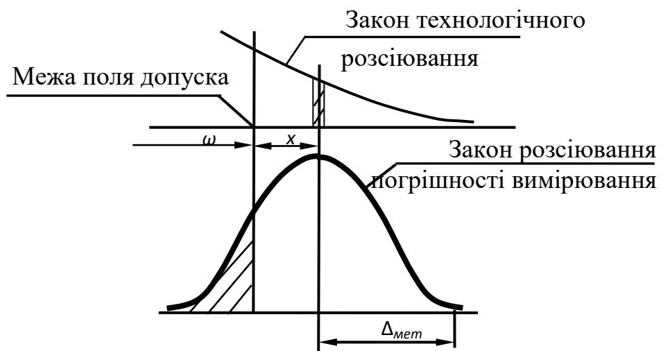
Рис.3 – Взаємодія похибки вимірювання і технологічного розсіювання розмірів
