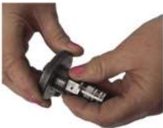
Рис.4. Контроль різьби непрохідним різьбовим кільцем
