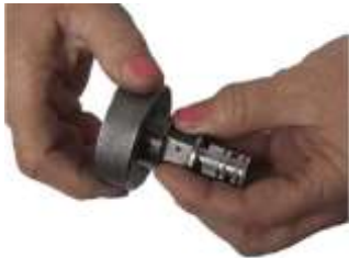
Рис.3. Контроль різьби прохідним різьбовим кільцем
